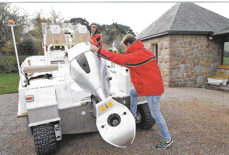
Le chantier a conçu un mode de stationnement situé à 5 cm du sol. Il permet de monter à bord plus facilement. Notez la présence d'une poignée sur le capot moteur.
