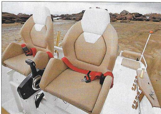
Les deux sièges baquets sont montés sur amortisseurs. Les ceintures sont amovibles et se rangent lors de la navigation.
