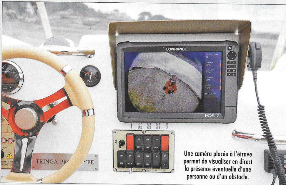
Une caméra placée à l'étrave permet de visualiser en direct la présence éventuelle d'une personne ou d'un obstacle.
